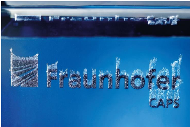
Bild 2: Großflächige UKP- Strukturierung in CAPS-User Facility: Wasserstoffentwicklung an Metallelektroden. © Fraunhofer ILT, Aachen.
