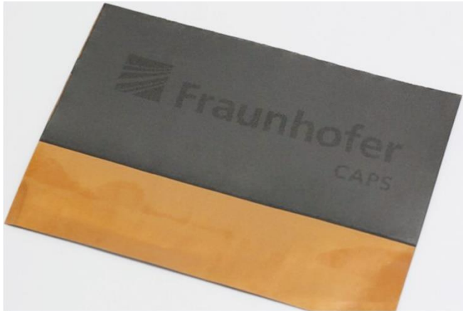
Bild 1: Laserstrukturiertes Anodenmaterial einer Li- ionen-Batterie. © Fraunhofer ILT, Aachen.
